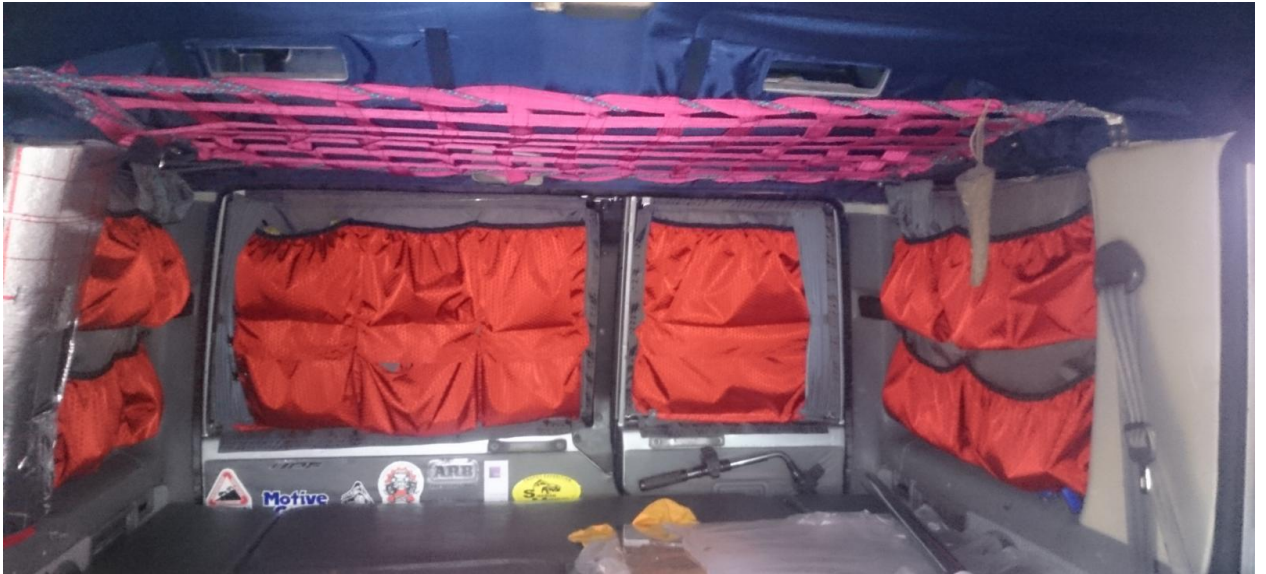
Фото № 37. Утепление салона и системы хранения
