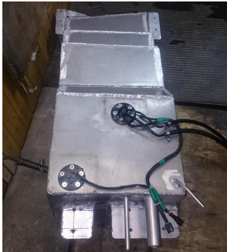
Фото № 38. Замена штатного бака на алюминиевый БОльшого объема
