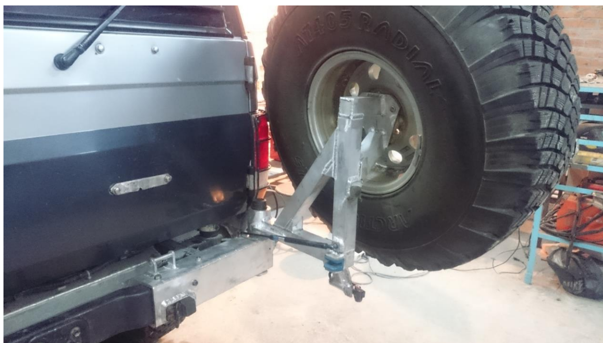
Фото № 32. Алюминиевая система крепления запаски
