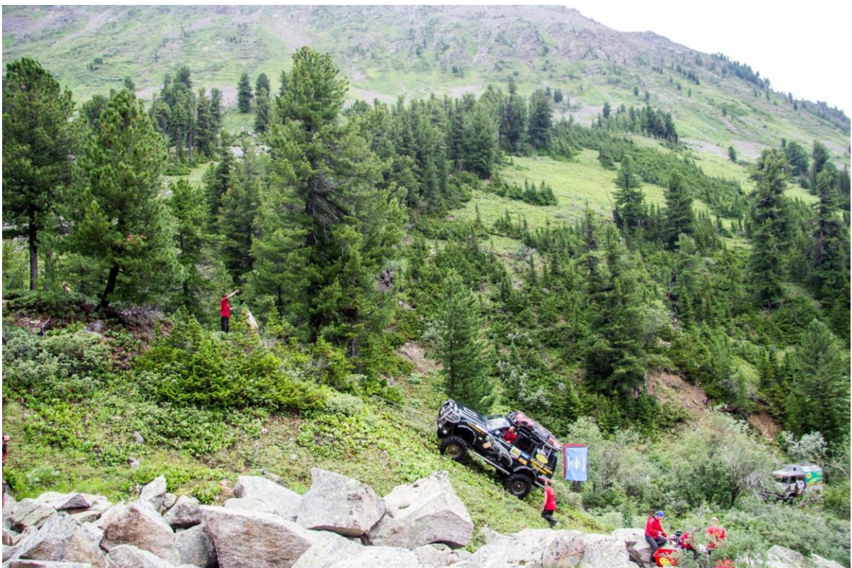
Выход из ручья. Подъём более 30°. Лебедка с дополнительной страховкой другим автомобилем.
