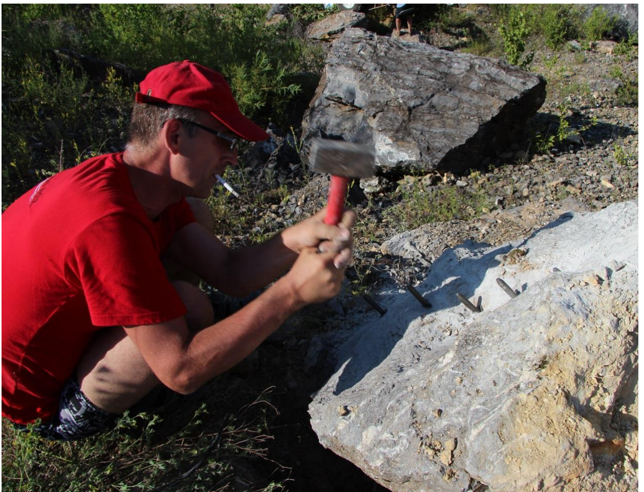
6. Отработка техники дробления камня с использованием камнекольных клиньев. Тренировочный выезд в заброшенный карьер.
