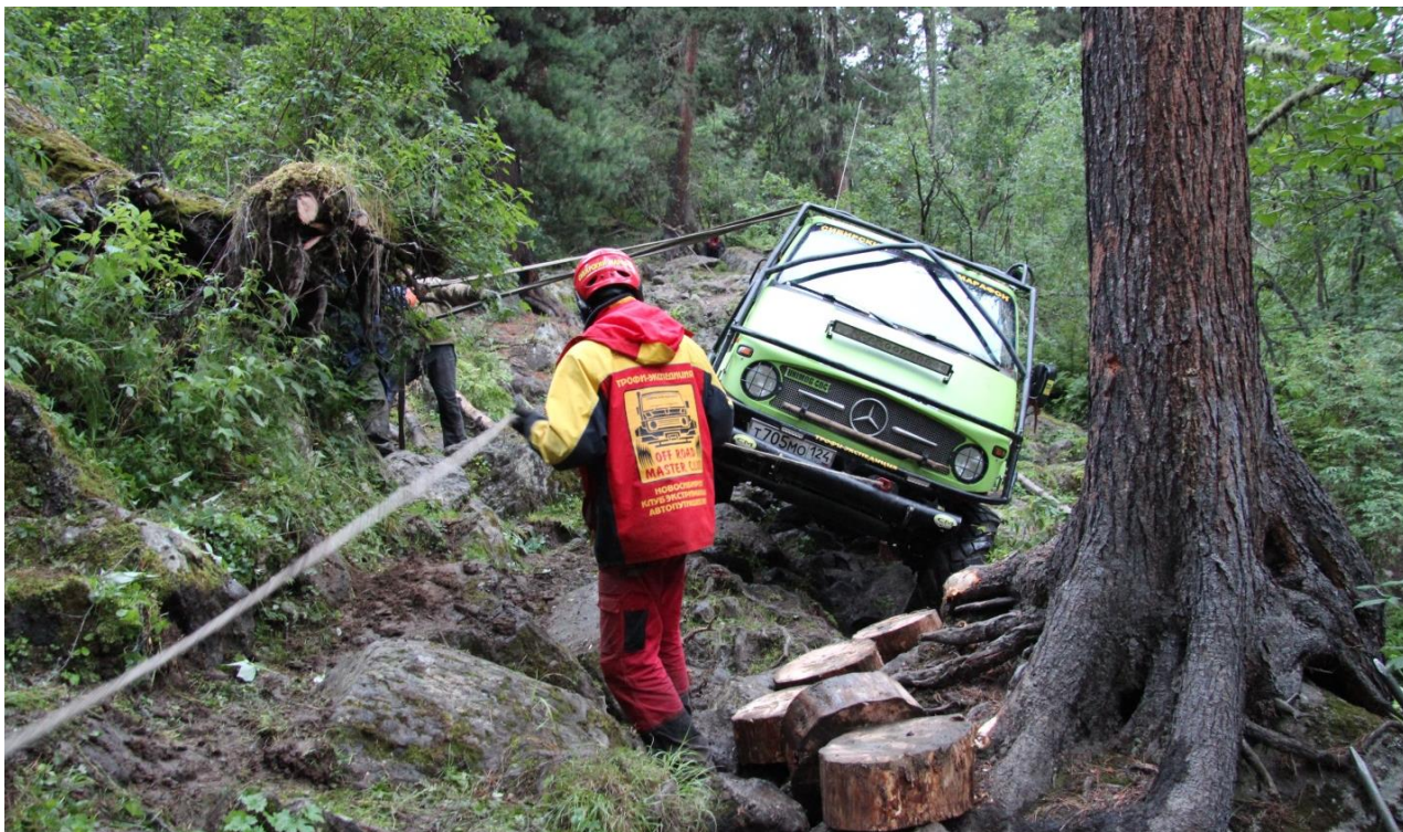
Лебёдка, отвешивание. Под колёса подкладывали распиленные поперёк брёвна.
