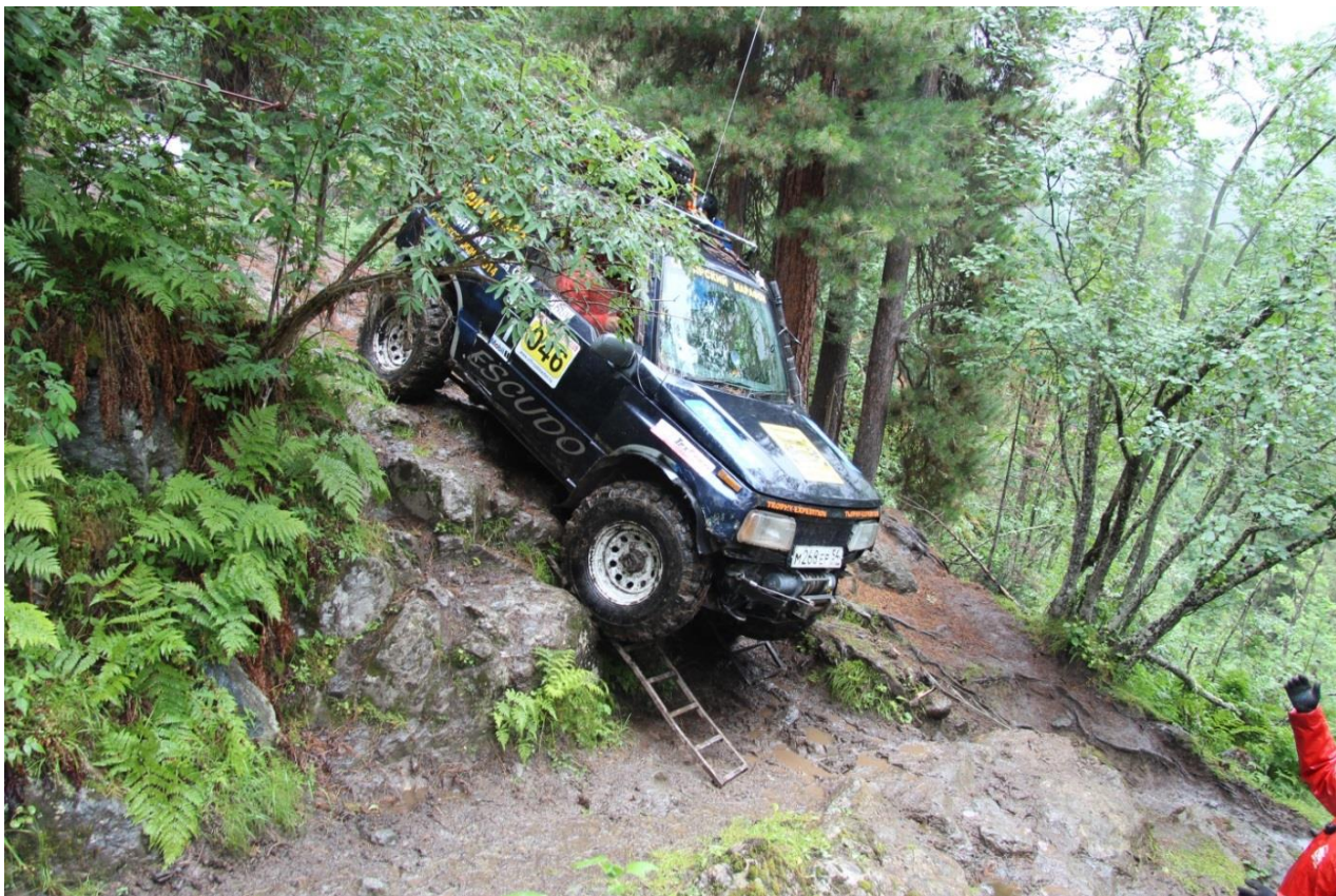
Скальный выход заканчивается невысоким свалом. Для Эскудо техника прохождения предусматривает использование сендтраков.
