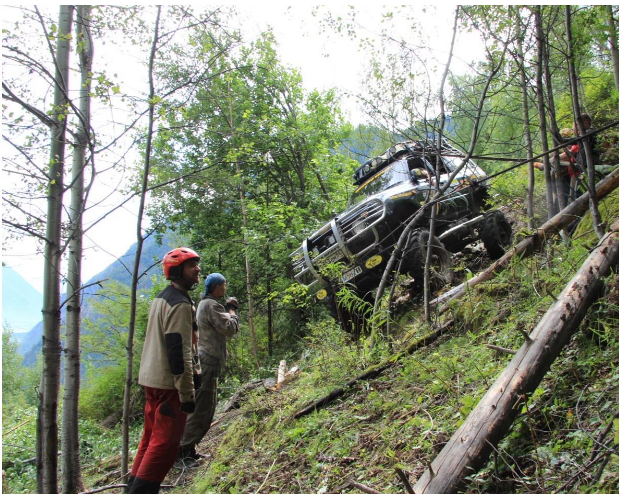
Спуск с траверсом к «нижним ленточкам». боковой уклон. 2 БСУ сзади, оттяжка с полиспасом сбоку, и страховка лебедкой спереди.
