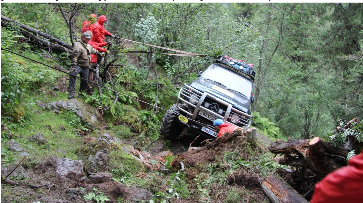
Использование лебёдки и боковые отвешивания при прохождении кренов.
