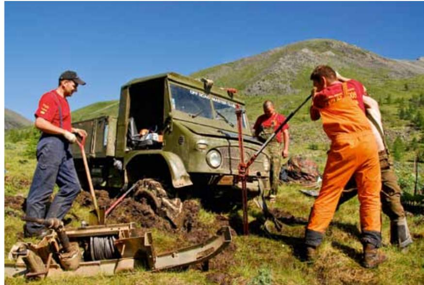
ность» маршрута. В один из дней вышел из строя выжимной подшипник сцепления на «восьмерке». Казалось, чего бы сложного. Но только не в случае с «Унимогом». Чтобы добраться до выжимного, нужно снять двигатель, а для этого демонтировать... кабину. Даже в условиях хорошо оснащенной СТО подобная операция вызовет массу вопросов. А как быть, когда вокруг тайга?!
