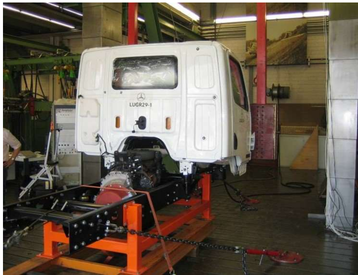
Fahrerhaustest ECE 29-2 Pendelschlag
