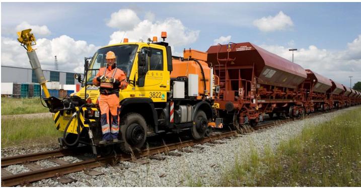
U 400 im Zweiwege-Einsatz auf der Schiene, Zugsgesamtgewicht bis zu 500 t
