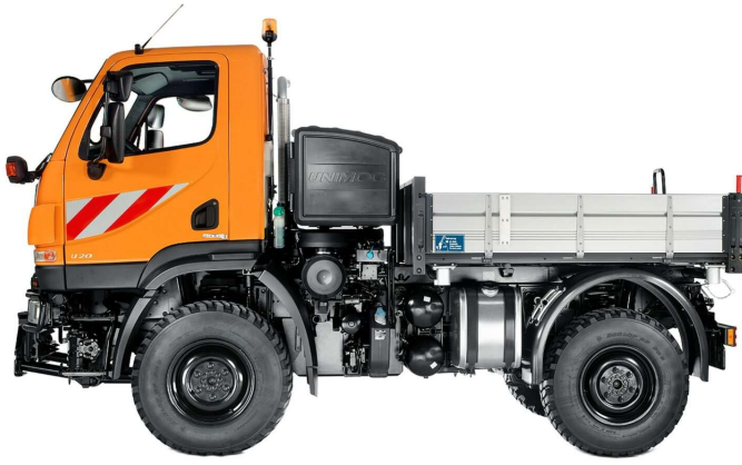
Kippbares, Stahlblech Frontlenkerfahrerhaus
