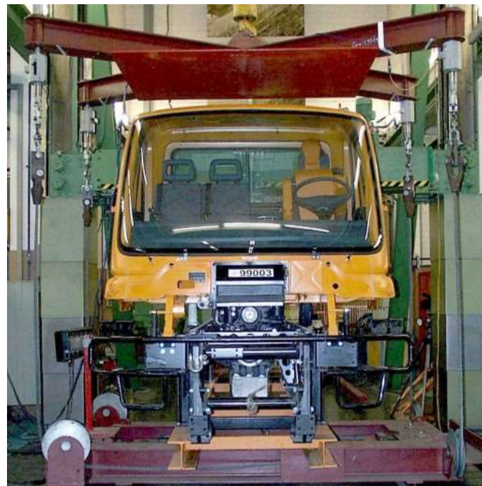
Kabinentest hier Dachlastest Kraft von oben
