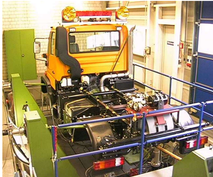
Hydopulstest Dauererprobung Festigkeit Fahrwerk und Kabine
